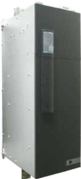
**SMB200** es un alimentador trifásico de CA /CC diseñado para suministrar una tensión constante a un bus DC-Link donde están conectados uno o más inversores. En el mismo bus se pueden conectar uno o más módulos de frenada con resistencias.
